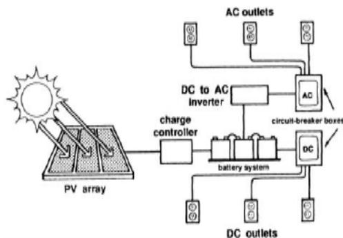
Fig. 2. Off Grid PV System.
